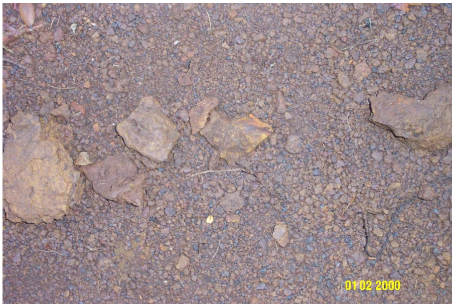
Gambar 3.5 Endapan besi laterit. Lokasi : Sorowako (foto pribadi)
