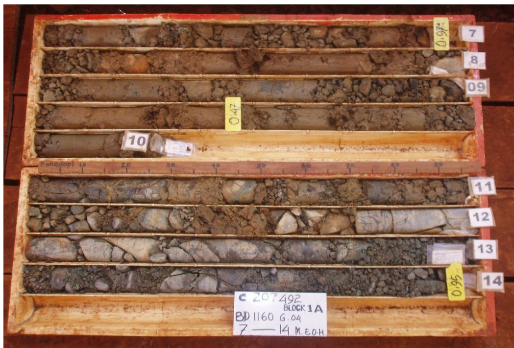
Gambar 3.2 Sampel tanah laterit dan batuan yang memperlihatkan hasil pelapukan kimia dan fisika
