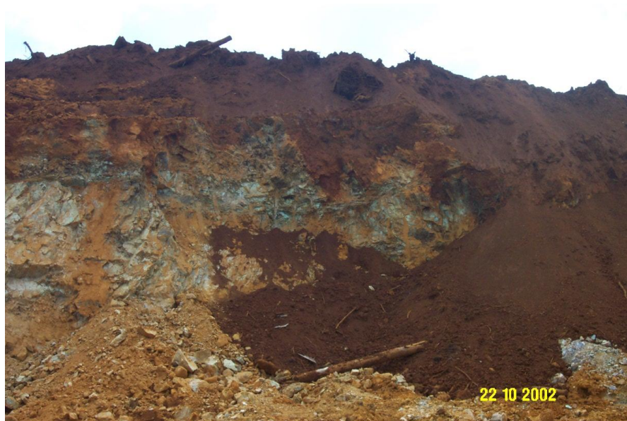
Gambar 3.4 Singkapan laterisasi tipe timur.Lokasi : Sorowako (Foto pribadi)
