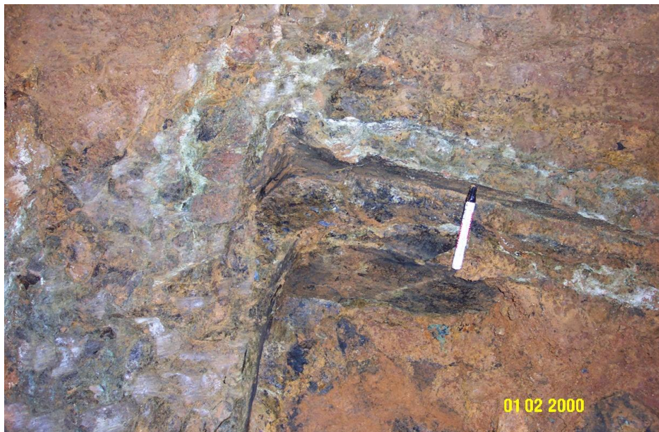
Gambar 3.11 Mineralisasi Ni-Co pada batuan ultramafic, (tanda spidol). Lokasi Sorowako (Foto pribadi).
