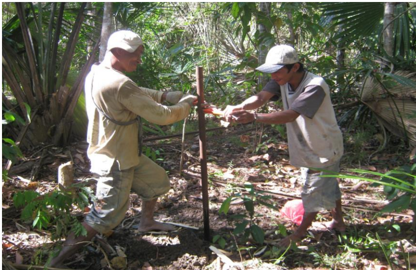
Gambar 4.5 Pengambilan sampel dengan auger drill, lokasi Pulau Kabaena Sulawesi Tenggara (foto pribadi)
