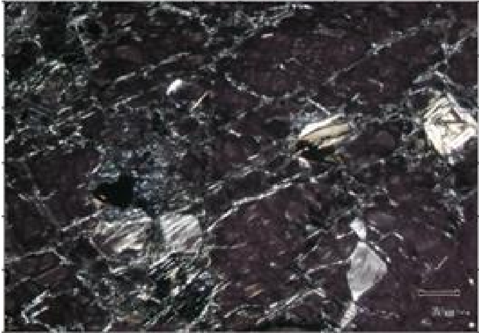
Gambar 2.9 Photomicrograph batuan peridotit warna absorpsi coklat dengan warna interferensi maksimum hijau kehitaman, tekstur kristalinitas holokristalin, granularitas faneritik, subhedral – anhedral, inequigranular. Mineral : plagioklas (bitownit), piroksin, mineral opak, serpentin, ukuran mineral 0,02 – 1,8 mm. Indeks warna 90 (Foto pribadi).
